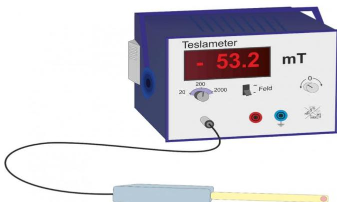
Das Teslameter ist ein Messgerät zur Messung der **magnetischen Flussdichte**. Die meisten Teslameter nutzen zur Messung der magnetischen Flussdichte den **Hall-Effekt**.
